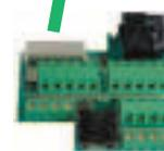
Kommunikationskarten für RS485, Modbus RTU, Device-Net oder Lonbus werden im Umrichter aufgesteckt und gestatten somit flexible Integrationsvarianten.
